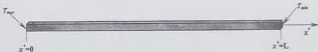
L'équation avec dimensions du problème s'écrit :  $\rho C \frac{dT}{dt} = k \frac{\partial^2 T}{\partial x^{*2}}$
