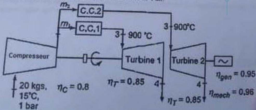
Figure 01 : Schéma de l'installation de turbine.
