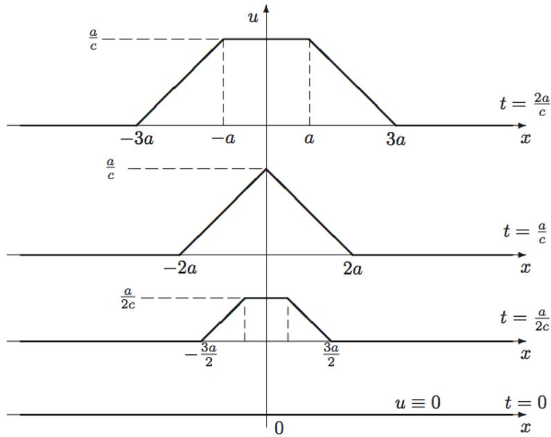
FIGURE 14. Déplacement de la corde en différents temps pour  $\psi$  donnée
