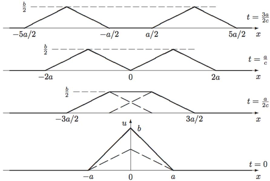
FIGURE 12. Déplacement de la corde en différents temps pour  $\varphi$  donnée et pour  $c = 4$
