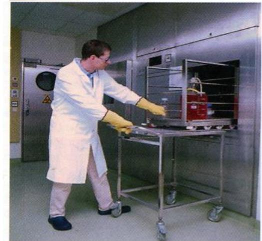
Figure 35 : Autoclave à double entrée. Sortie du matériel stérilisé à l'extérieur du laboratoire de niveau de sécurité 3
