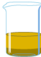
Après décantation, un liquide plus clair se trouve en haut du récipient alors que les particules lourdes sont tombées au fond.
