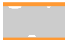
Mauvaise adhérence de l'isolant sur les électrodes
