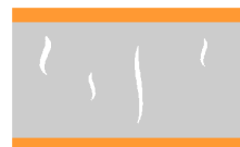
Fissure perpendiculaire, dans un élastomère
