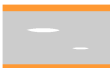
Cavité laminaire dans du mica
