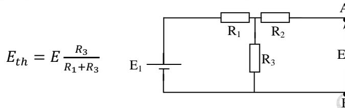
× Détermination de  $R_{th}$
