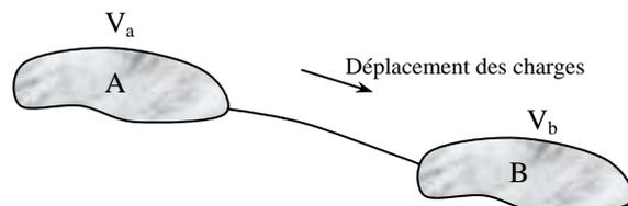
Si on relie les conducteurs A et B à l'aide d'un fil conducteur, l'ensemble A, B et le fil constitue un conducteur unique, pour lequel l'état précédent n'est plus en état d'équilibre.
