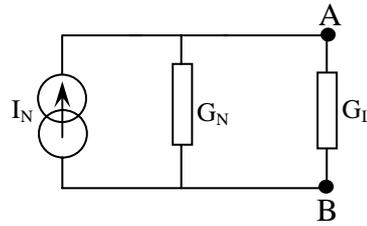
$$I_L = \frac{G_L}{G_L + G_N} I_N = I \frac{G_3}{G_1 + G_3} \frac{G_L}{G_L + G_N} = I \frac{G_3}{G_1 + G_3} \frac{G_L}{G_L + G_2 + \frac{G_1 G_3}{G_1 + G_3}}$$
