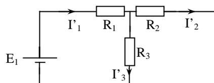
$$I'_1 = \frac{E_1}{R_1 + \frac{R_2 R_3}{R_2 + R_3}} \Rightarrow AN. \quad I'_1 = \frac{10}{1,2 \cdot 10^3 + \frac{1,8 \cdot 10^3 \cdot 2,7 \cdot 10^3}{1,8 \cdot 10^3 + 2,7 \cdot 10^3}} = 4,386 \text{ mA}$$
